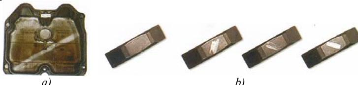
Slika 6. Spoljašnji izgled poklopca (a) i klackalica (b) nakon primene različitih kvaliteta ulja
