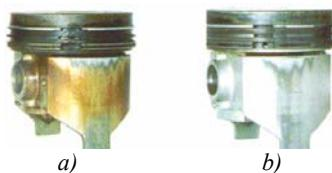
Slika 5. Spoljašnji izgled klipa primenom niskokvalitetnog (a) i visokokvalitetnog (b) ulja
